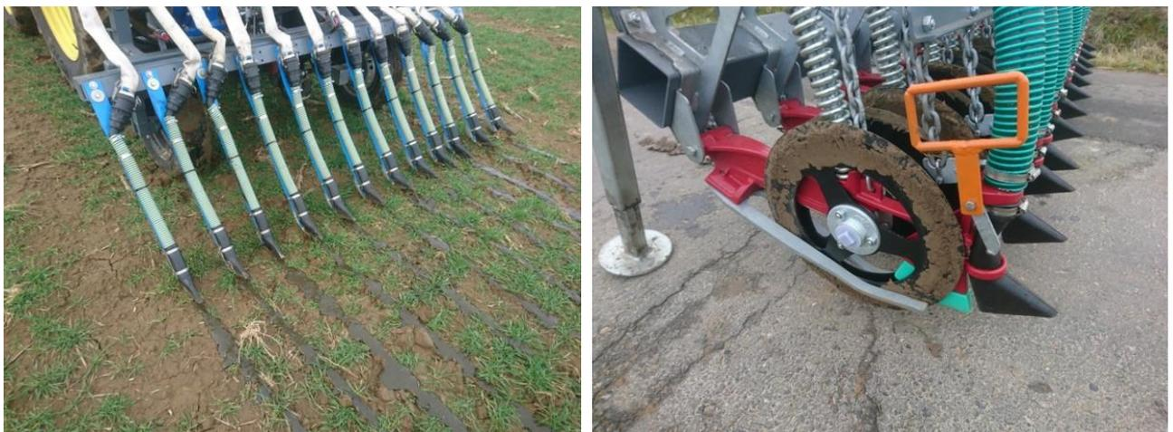
Abb. 7: Unterschiedliche Ausbringtechniken der organischen Dünger (links Schleppschuh, rechts Schlitzgerät) in den Exaktversuchen der LWK Niedersachsen im Versuchsjahr 2018
