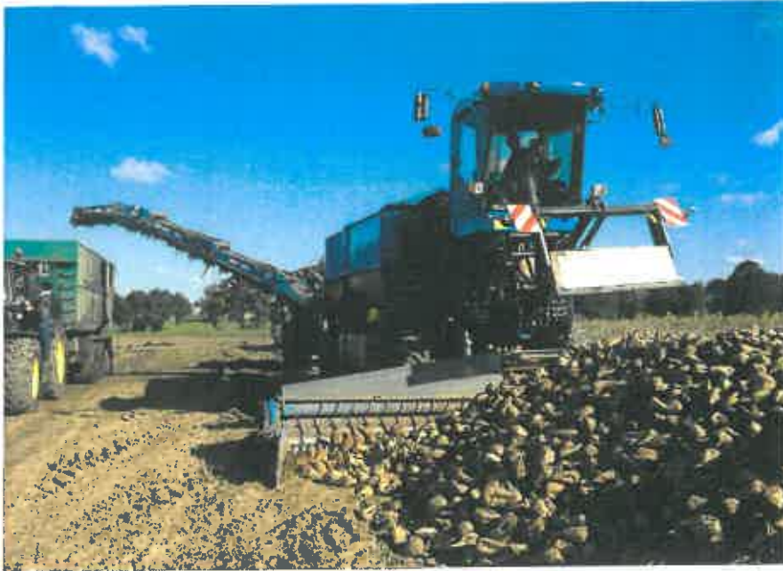
Derzeit ist die Waschmaus in der Lage, bis zu ca. 90 t in der Stunde aufzunehmen, zu waschen, zu entsteinen und an Transportfahrzeuge zu übergeben. Fotos: Hermus/Putsch
