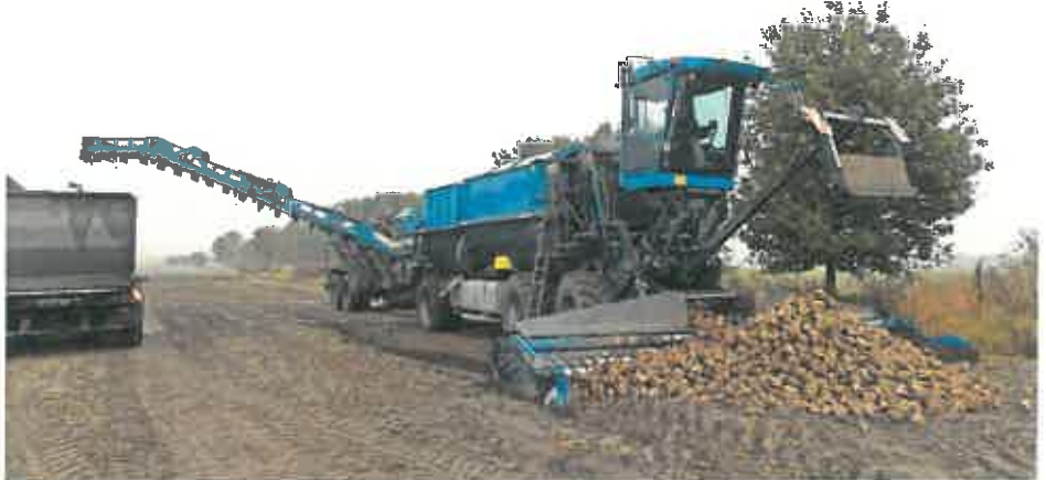
„Waschmaus“ wird diese Maschine genannt, die direkt am Rübenacker zum Einsatz kommt und die Feldfrucht dort wäscht. Das macht die Nutzung der Rübe deutlich wirtschaftlicher und damit auch für den Einsatz in Biogasanlagen interessanter. Foto: Kerber
