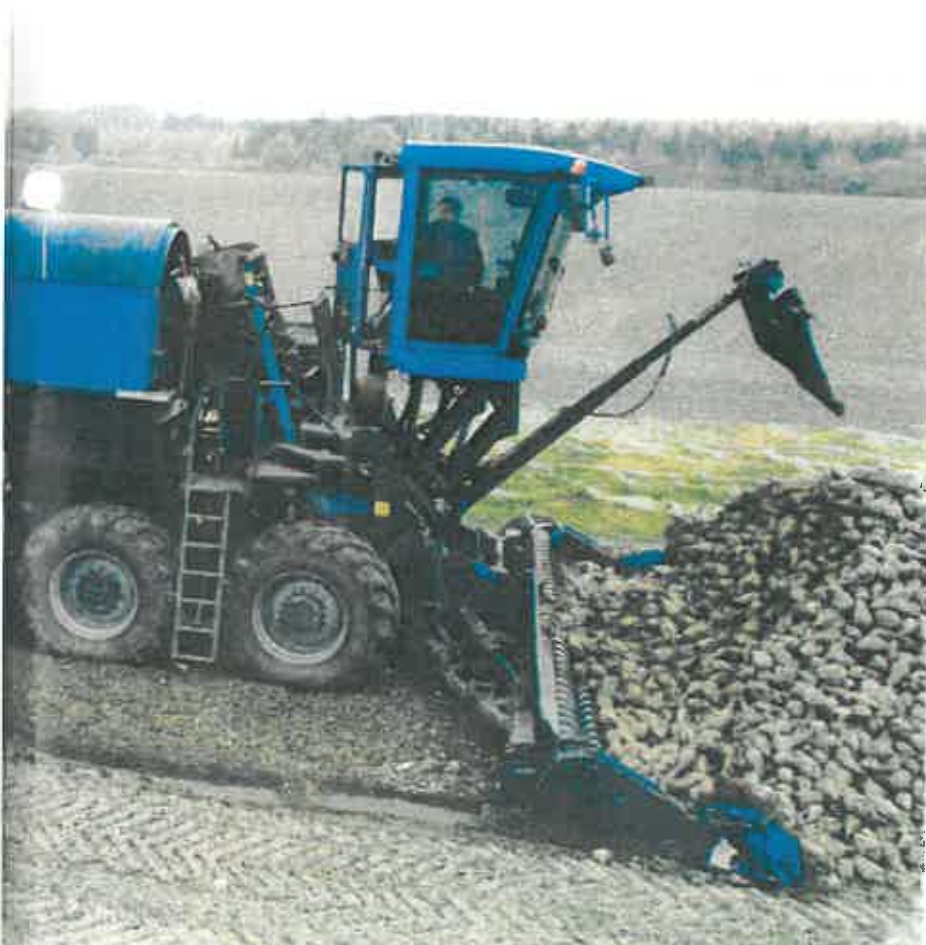
Das Kraftwerk ist mit 320 PS nicht überdimensioniert, trotz überarbeiteter Motorsteuerung. Die elf Hydraulikpumpen brauchen Kraft satt. Fotos: Schulz
