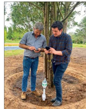
Aktivierung des Sensors, der einem Ort zugeordnet wird. Die App von Agvolution zeigt dann alle aktiven Sensoren mit Standort und Messwerten.
