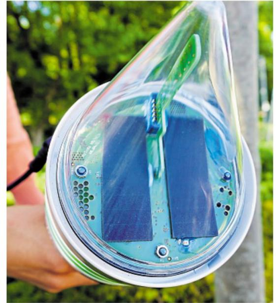
Die Mikroklimasensoren werden über Solar betrieben (hier zwei kleine Solarplatten im Sensorkopf)
