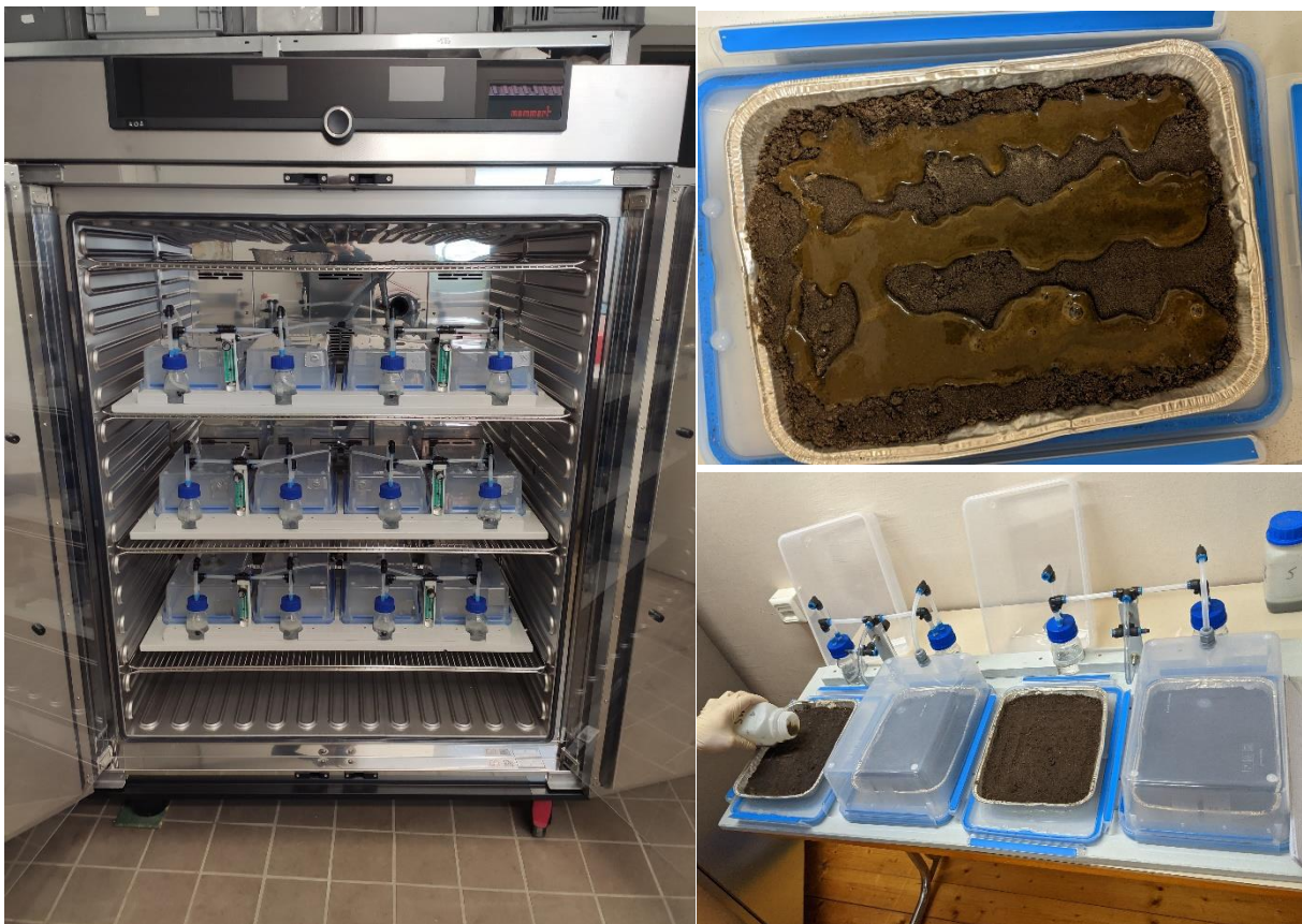
Abbildung 10 – Aufbau der Inkubationsapparatur und Applikation der Gülle. Links ist die komplette Inkubationsapparatur im Klimaschrank, rechts oben die in einer Aluschale auf Boden applizierte Gülle und rechts unten der Vorgang der Gülleapplikation zu sehen.
