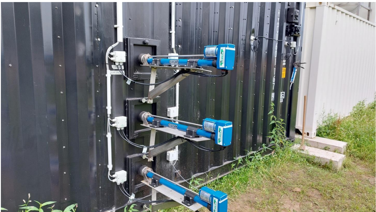
Abb. 10: Linearaktuatoren zum Einschieben der Temperatursonden in das Kompostmaterial
