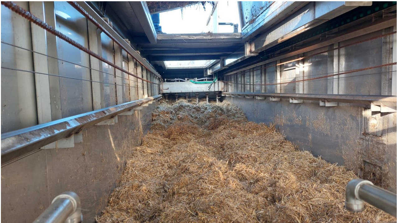
Abb. 6: Stroheingabe in den Kompostiercontainer über Dachluken
