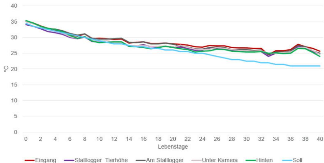
Abbildung 35 Temperaturverlauf (in °C) während eines Durchgangs im Versuchsstall im Sommer
