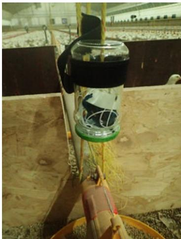
Abbildung 36 Lichtlogger im Stall auf Tierhöhe für die Erfassung der Lichtintensität (Lux)
