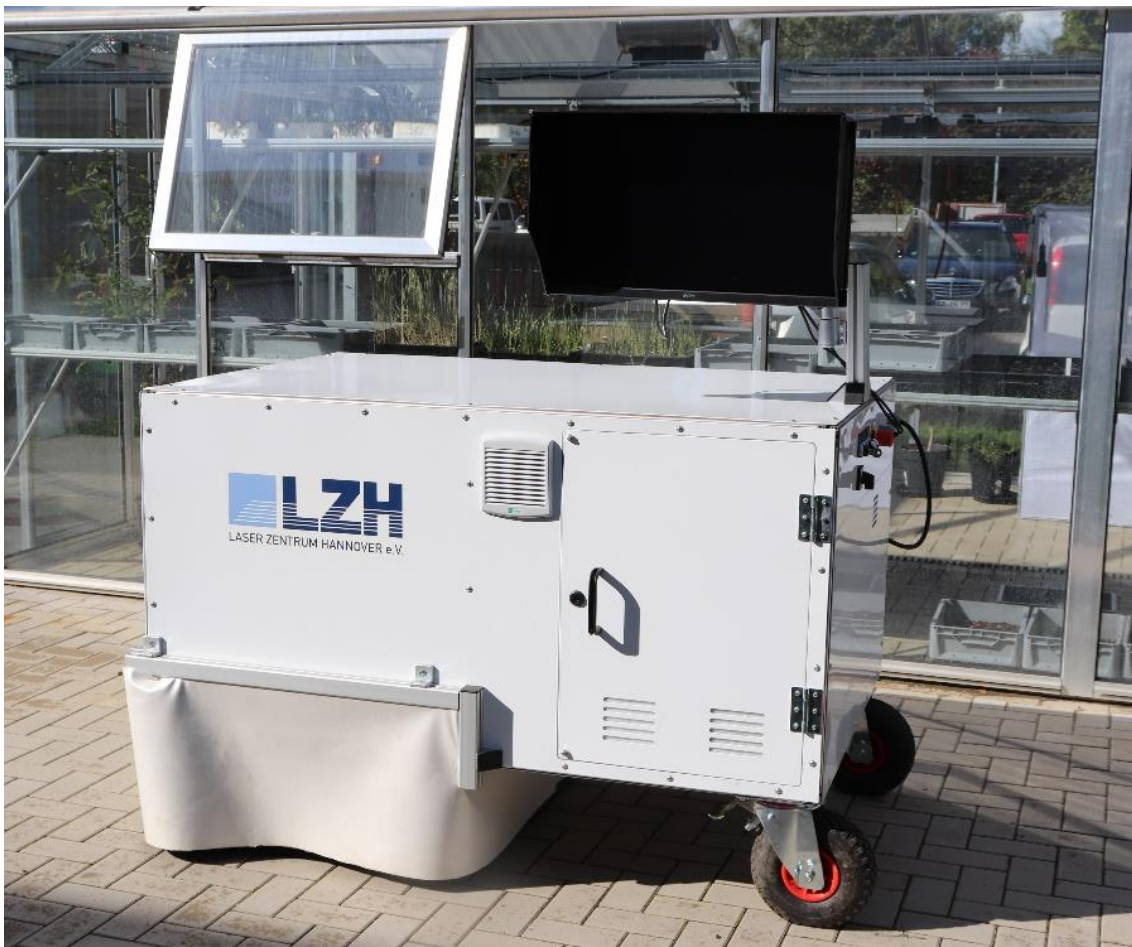
Abbildung 22 Laserapplikator des Laser Zentrum Hannover basierend auf einem handgeführten Rollwagen ausgestattet mit Lasermodul, Achssystem, Kameratechnik, Beleuchtung, Computertechnik und in einem Schaltschrank verbauter Sicherheitssteuerung und Energieversorgung.
