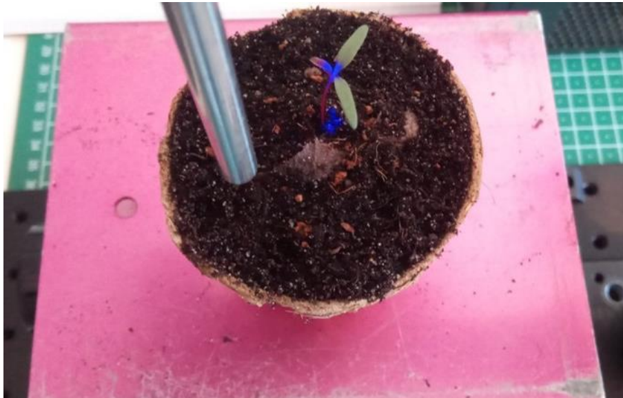
Abbildung 17 Exemplarische Darstellung der Laborversuche an einer Pflanze AMARE. Der Bestrahlungspunkt der dikotylen Pflanze ist primär das Apikalmeristem (beleuchtet in Blau).
