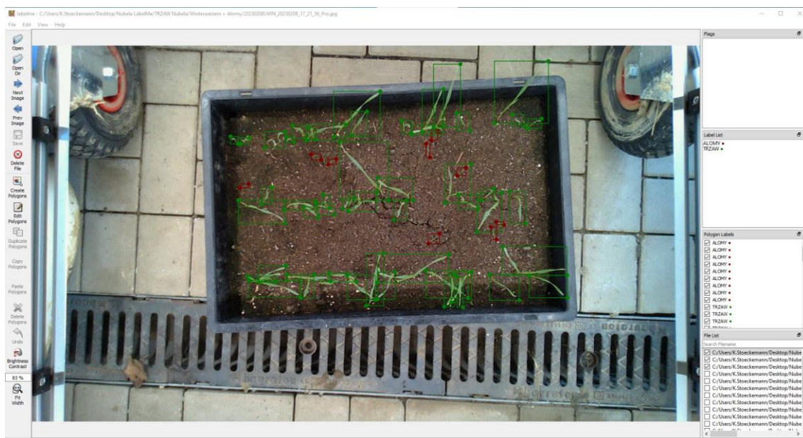
Abbildung 30 Manuelle Markierung jeder einzelnen Pflanze mit zugehöriger Benennung als Trainingsgrundlage für die automatische Pflanzen- und Zielerkennung mittels „labelme“.
