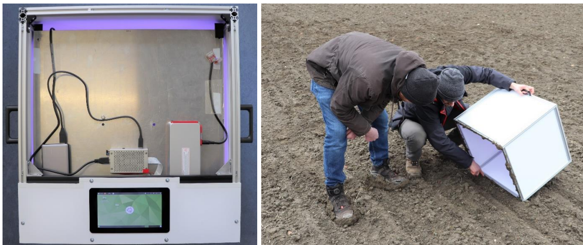
Abbildung 26 Mobile Fotobox zur Datensammlung für die automatische Zielerkennung. Links: Fotobox (Version 1) bestehend aus RaspberryPi, Display und Batterien, sowie LEDs zur Beleuchtung der Feldfläche und Kamera auf der Unterseite. Rechts: Praxiseinsatz der Fotobox V1.
