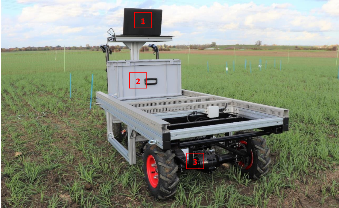
Abbildung 20 Erste Feldbegehung mit dem Trägerfahrzeug inklusive Laserapplikator. Das Trägerfahrzeug beinhaltet u. a.: Eine Steuereinheit für den Laserapplikator (1), eine sichere Einhausung von Steuerungselektronik und Energieversorgung (2) sowie ein 2D-Achssystem (3).
