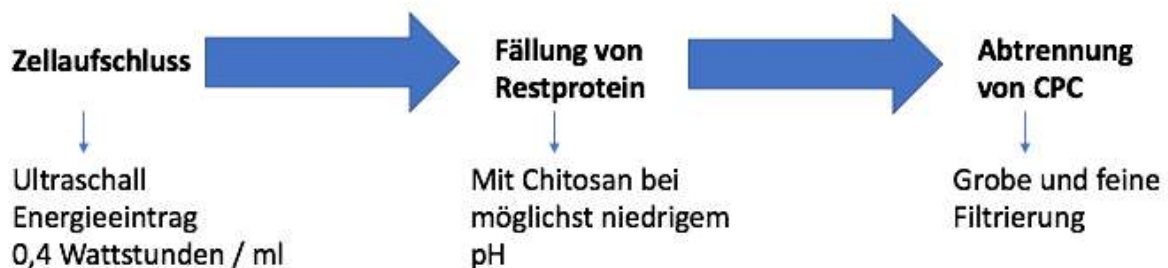
ABBILDUNG 6: SCHEMATISCHER EXTRAKTIONSABLAUF IM LABOR
