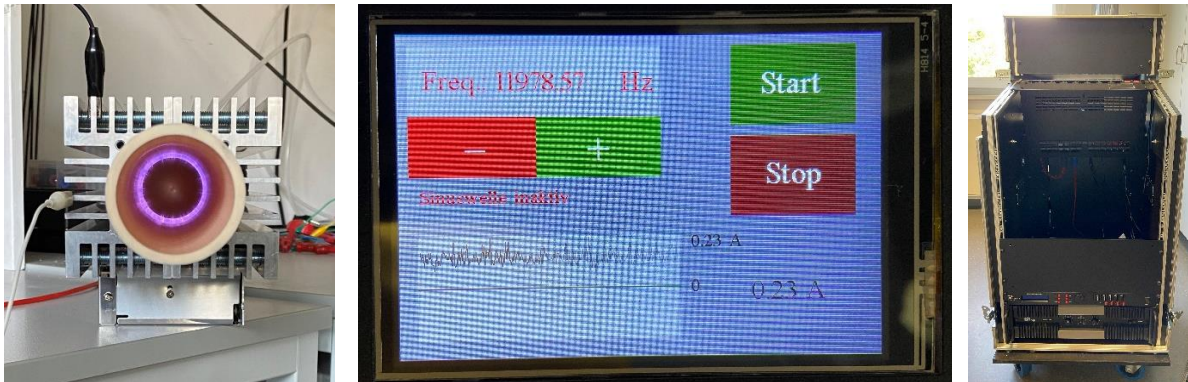
Abbildung 29: Plasmaentladung beim Wicklungsverhältnis 10:104 (links), graphisches User-Interface (mitte), Eigenkonstruktion HV-Generator mit Beschallungstechnikkomponenten (rechts).
