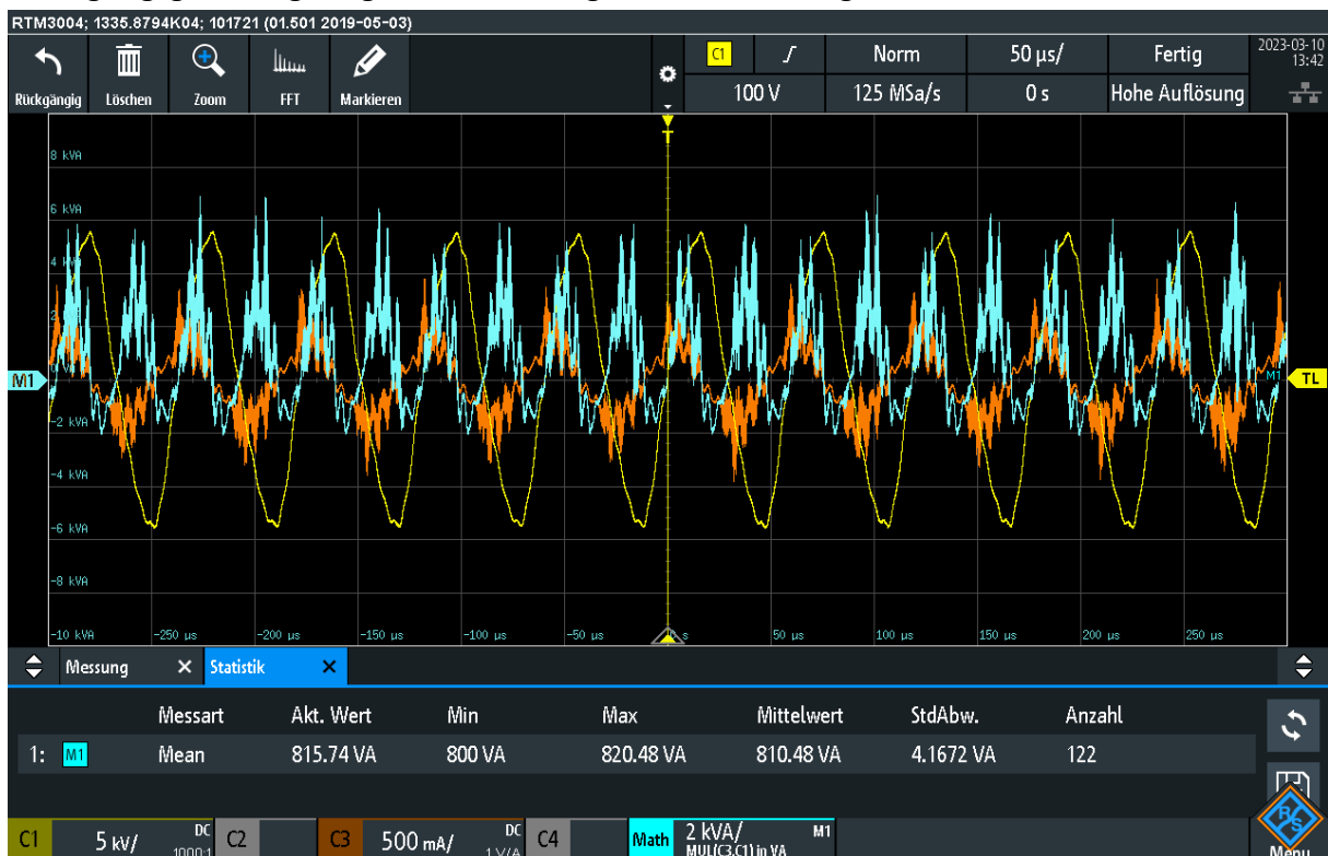
Abbildung 31: U-I-Chrakteristik bei 850W Ausgangsleistung des Tantec-HV-X20.
