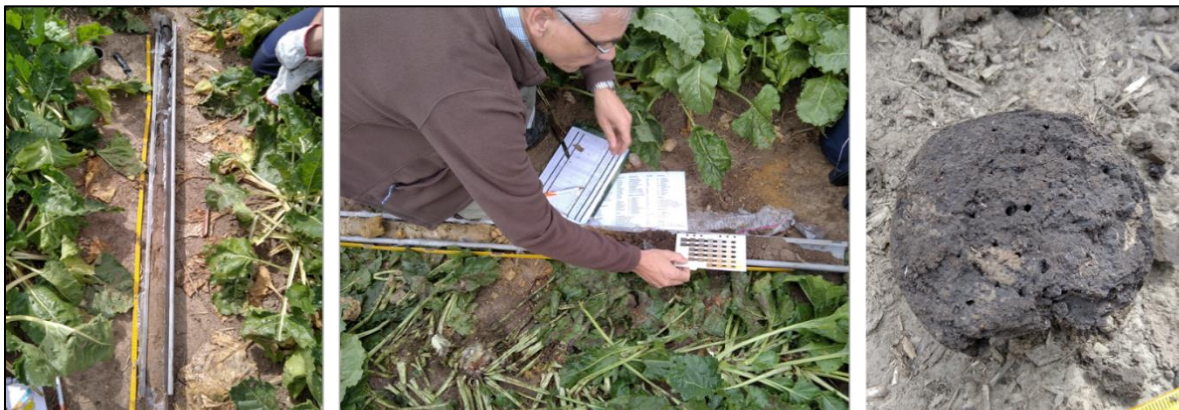
Abbildung 6: von links nach rechts: (1) Bohrkern auf Versuchsschlag in Klein Dahlum, (2) Ansprache der verschiedenen Bodenhorizonte durch Dr. Lorenz, (3) Bohrkernquerschnitt in ca. 1,40 m Tiefe zeigt zahlreiche Grobporen und eine starke Durchwurzelung.
