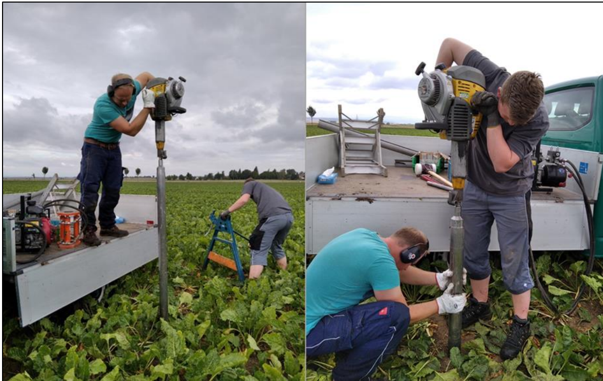
Abbildung 5: Rammkernsondierung auf dem Versuchsschlag am 24.08.2020 in Klein Dahlum.
