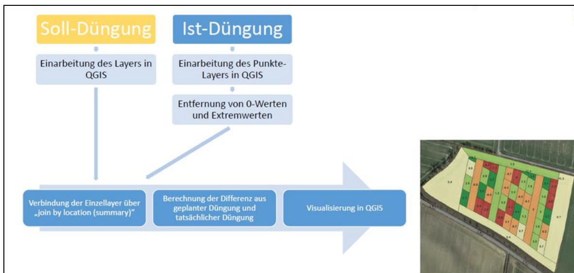
Abbildung 21: Workflow der Soll/Ist-Auswertung (links) anhand des Beispielschlagles Olla (rechts).
