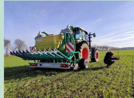
Bild 1: Das Team bringt mit einem Versuchsgüllefass die mit dem Sorbenten gemischte Gülle im Feldversuch aus und stellt gleichzeitig Ammoniak-Passiv-Sammler zum Messen der Emissionen auf. Foto: Hochschule Osnabrück
