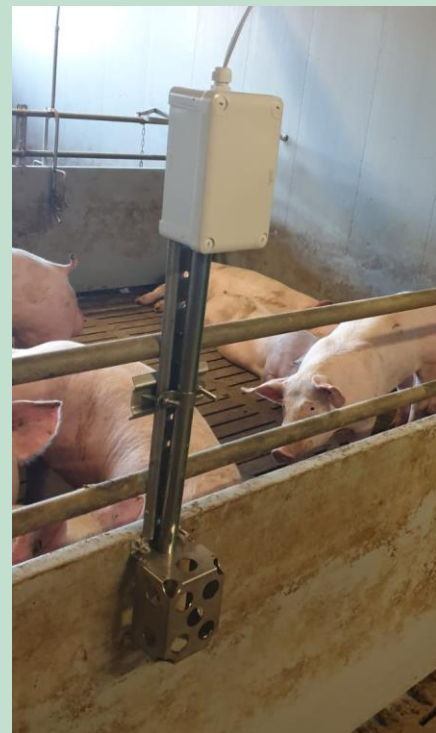
Bild 2: Halterung für die Sensortechnik im Stall. Foto: Dr. Hubert Gerhardy
