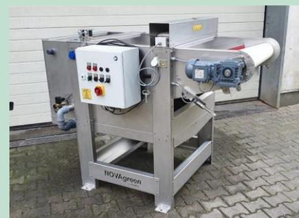
Bild 4: Bandfiltrationserntegeräts der Firma NOVAgreen. Foto: Evergreen-Food, Cathleen Cordes
