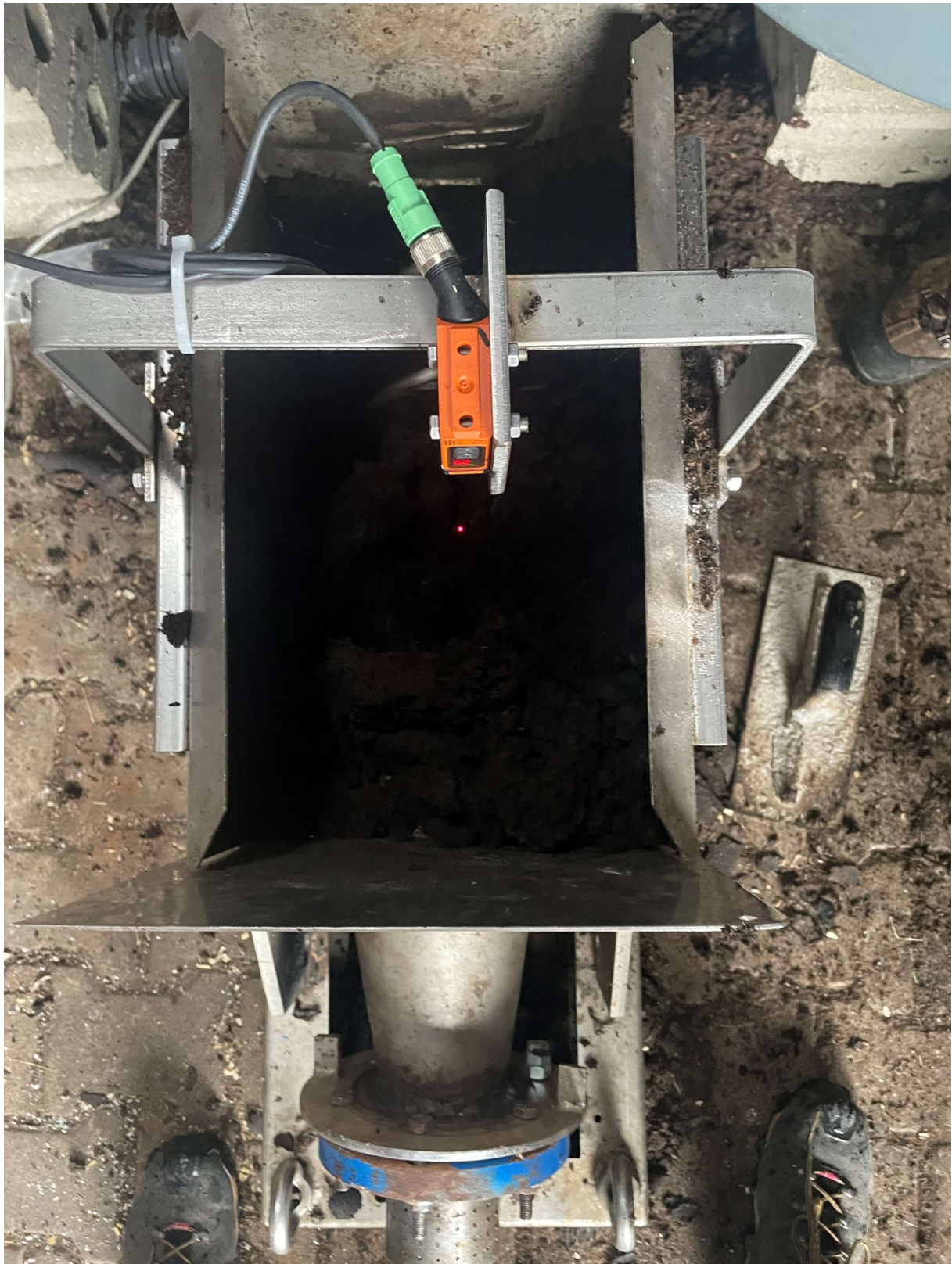
Lichtsensoren zur Steuerung der Zufuhr, überschüssiges Substrat wird aus dem Pressvorgang zurückgedrückt
