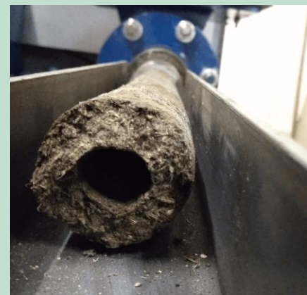
Bild 2: Das Düngerrohr besteht aus separierter Gülle (Foto: Rolf Sieling, DEULA-Nienburg GmbH)
