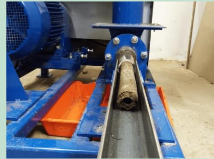
Bild 1: Herstellung des Düngerrohr (Foto: Rolf Sieling, DEULA-Nienburg GmbH)
