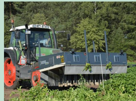
Bild 2: Prototyp zur elektrischen Sikkation: Mit Hilfe flexibler Applikatoren wird ein elektrischer Impuls in den Kartoffelbestand gegeben. (Foto: Andreas Meyer, Versuchsstation Dethlingen)
