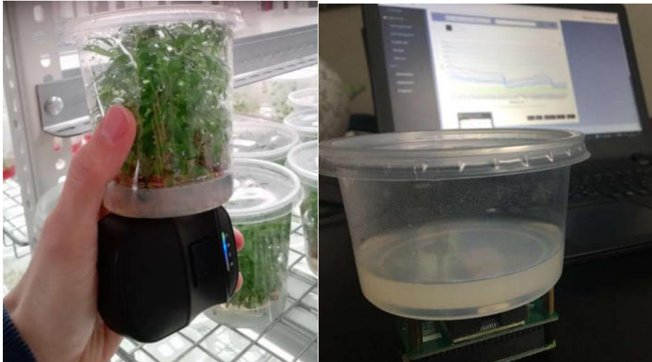
Abbildung 12: Messung der Nährstofflösung direkt an einem optischen Fenster
