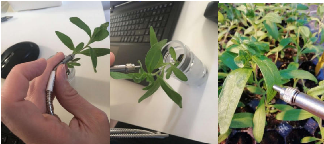
Abbildung 11: Messung der Zistrose mit einem Lichtwellenleiter
