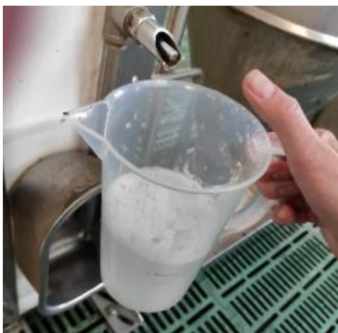
Abb. 7a. Test, ob Reinigungslösung erfolgreich aus dem System entfernt wurde, was hier noch nicht der Fall ist (Schaumbildung).
