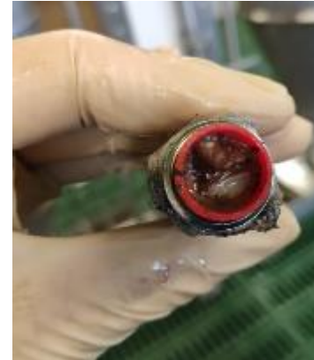
Abb. 2c. Reinigung von verunreinigten Nippeln (Partner 1)
