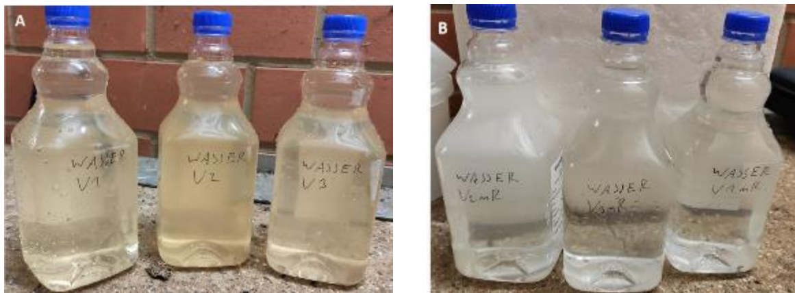
Abb. 1. Wasserproben vor (a) und nach (b) Reinigung im Partnerbetrieb1 im 1. Durchgang
