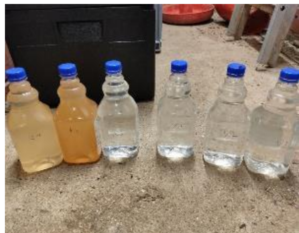
Abb.7b. Wasserprobenentnahme nach Reinigung (Kontrollabteil (keine Reinigung): linke 3 Proben, Versuchsabteil (nach Reinigung): rechte 3 Proben).
