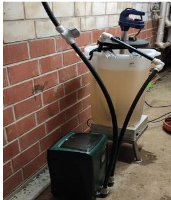
Abb. 5b. Druckkonstantpumpe und Anmischbehälter auf Magnetrührer
