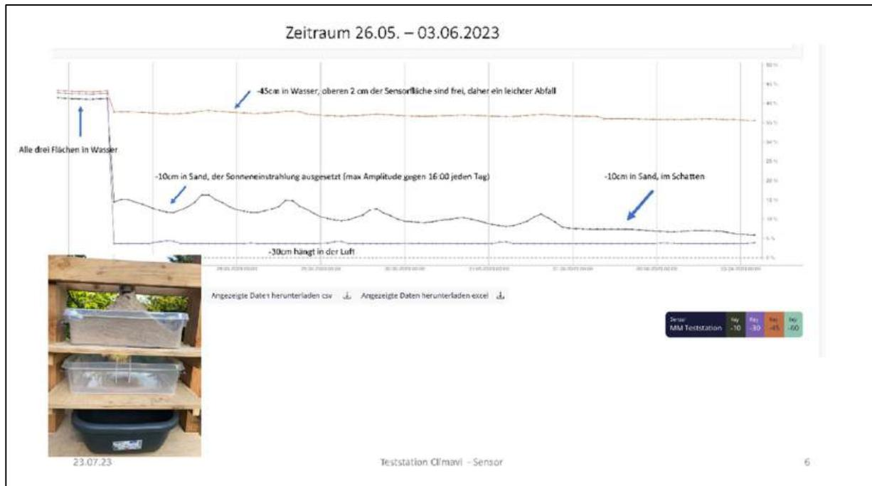
Abbildung: Beispiel einer Messreihe in FARMALYZER App – Wasser, Luft, Sand
