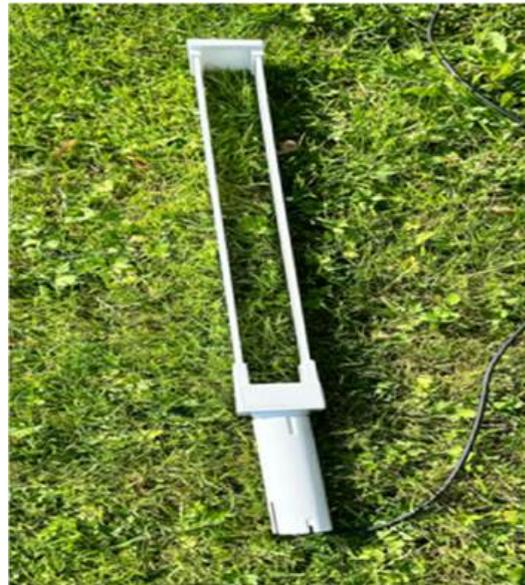
Abbildung: Ein Abstandshalter am Fußende sorgt für einen parallelen Verlauf der beiden Messfüße
