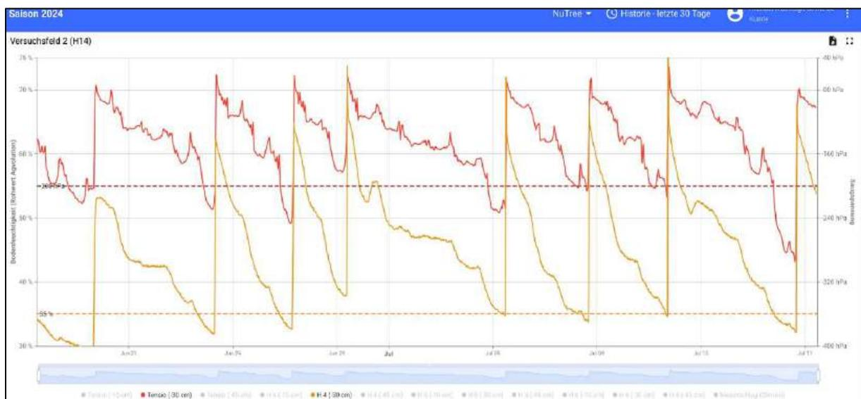
*Abbildung: Vergleich der Verläufe der Zeitreihen eines Tensiometers (rot, rechte vertikale Achse, hPa), AGVOLUTION dielektrischer Sensor (orange, linke vertikale Achse, % normalisierte Kapazität), am selben Standort für den -30 cm Horizont; vgl. Bild in Abschnitt Baumschule Bonk.*
