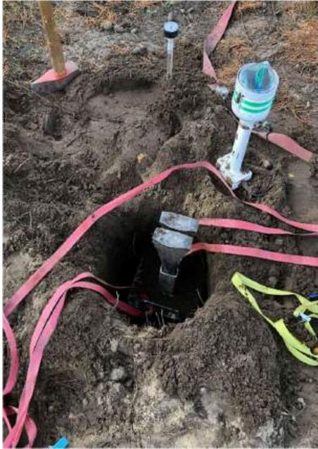
Abbildung: Die Führungslöcher für den Sensor- Fuß sind eingeschlagen
