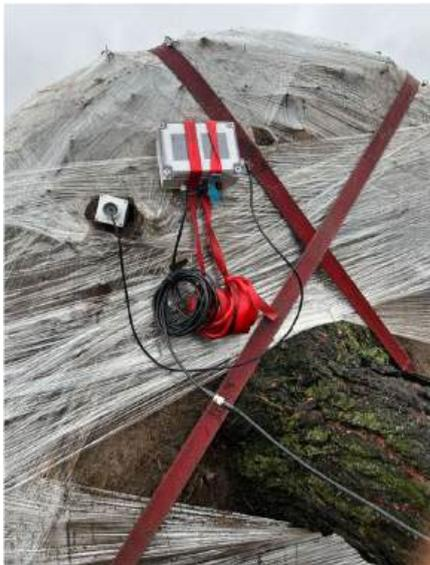
*Abbildung: Die Transportbox mit angeschlossenen Sensoren*
