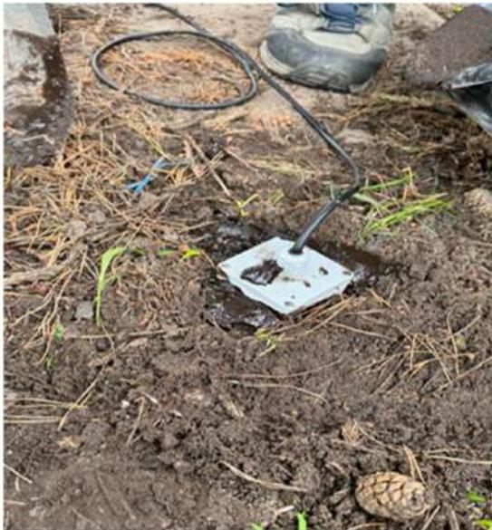
Abbildung: Der eingeschlammte Sensorfuß
