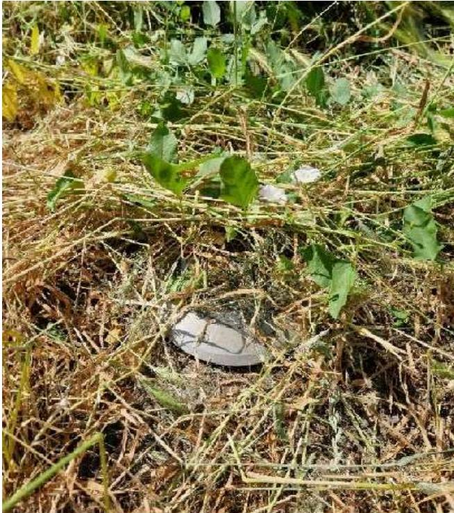
*Abbildung: CLIMAVI-City Sender ist mit Grünschnitt bedeckt/ zugewachsen.*
