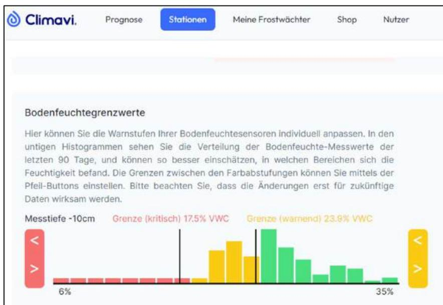
Abbildung: Einstellung der Bodenfeuchte-Grenzwerte im Climavi-Dashboard
