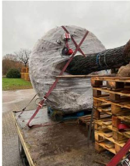
*Abbildung: Instrumentierter Baum vor dem Verladen auf den Transporter*
