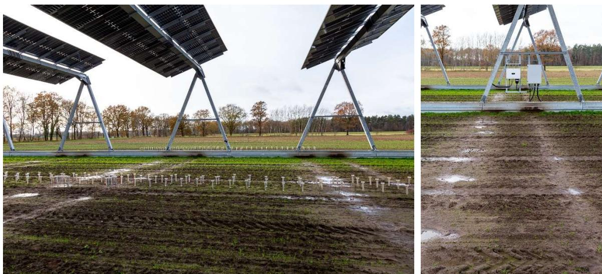
Abbildung 5: Linkes Bild: Niederschlagsmesser unterhalb der Agri-PV Anlage. Im Hintergrund ist das Referenzmessfeld außerhalb der Anlage zu erkennen. Rechtes Bild: Darstellung der Abtropfkanten im Feld.
