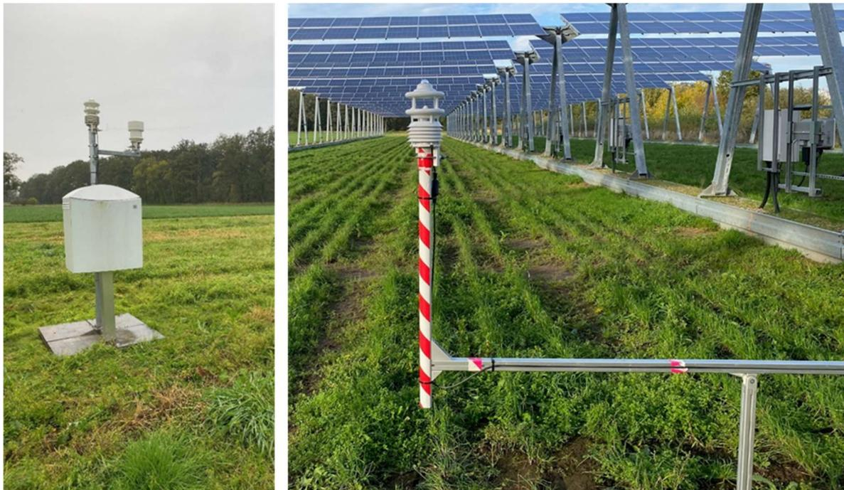
Abbildung 9: links: Wetterstation mit Niederschlagsmessung außerhalb der APV, rechts: Wetterstation unter APV
