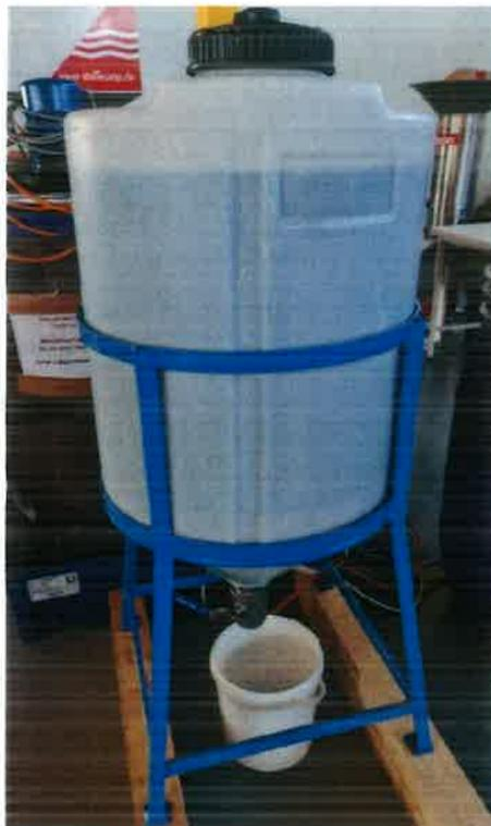
*Abbildung 12 – Sedimentationstank für Mikroalgen-Medium, der in der Lage ist, niedrige pH-Werte aufrechtzuerhalten.*
