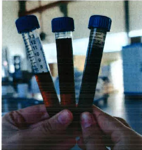
Abbildung 16 – Proben des Mikroalgenkultivierungsmediums (die ersten beiden links) und konzentrierte Mikroalgen-Rückstände (rechts).
