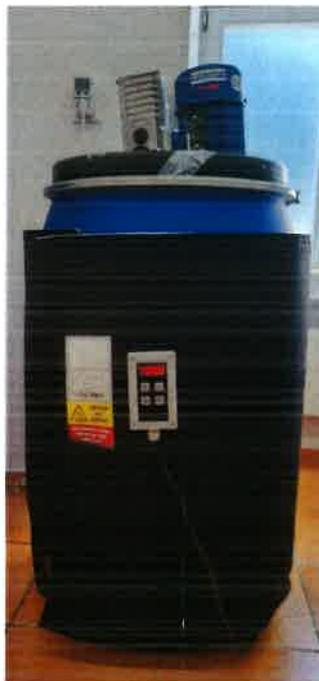
Abbildung 19 - Das Hydrolysat sollte nach der Hydrolyse umgehend auf pH 2 eingestellt und für 24 Stunden auf 60-70°C erwärmt werden, um vegetative Formen von Kontaminationen unschädlich zu machen.
