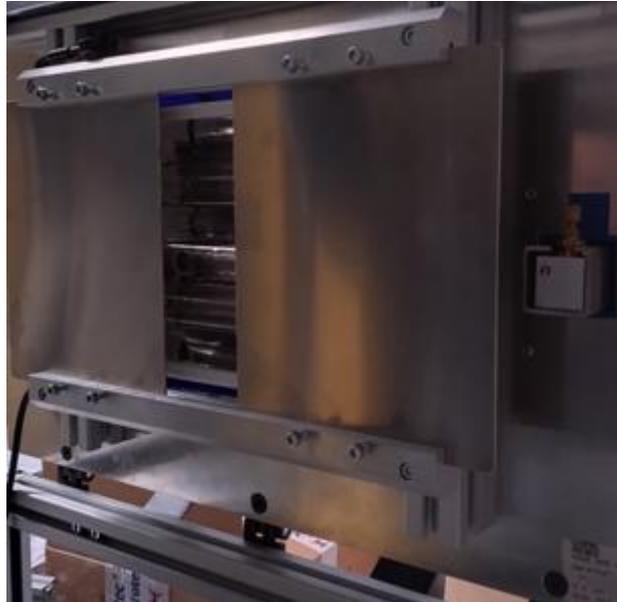
**Abb. 42:** Vorrichtung zur Regulierung der Lichtspaltbreite
