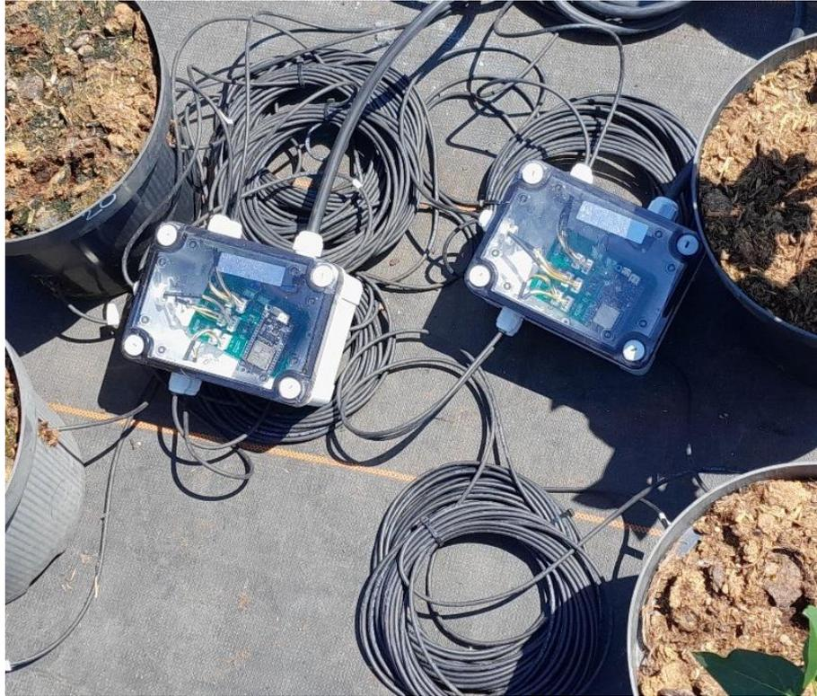
*Abbildung 16: GBox mit Verbindung zu SMT100 Sensor*
