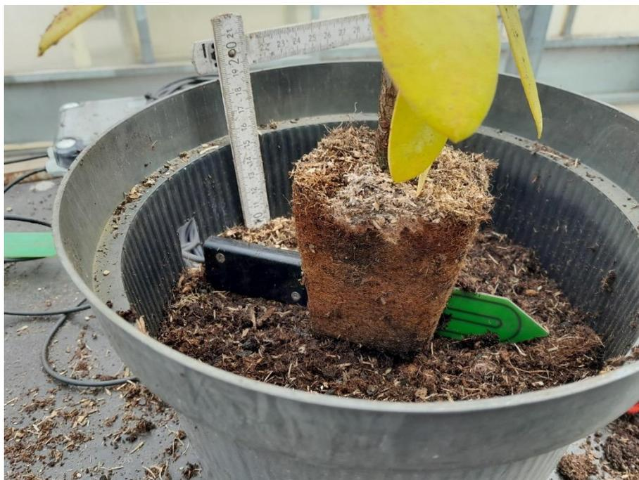
Abbildung 15: SMT100 Sensor (Truebner) zur Messung der Bodenfeuchtigkeit und Temperatur
