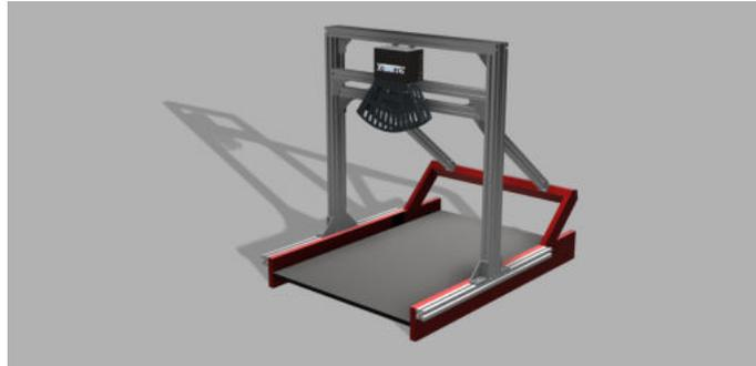
Abbildung 4: CAD-Visualisierung des Gestells für die Erntemaschine Grimme SE75/85
