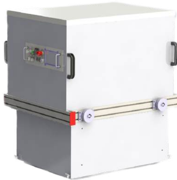
Abbildung 7: Laserwerkzeug in der Konstruktionsumgebung. Die Hauptkomponenten des Laserwerkzeugs liegen oberhalb des Werkzeugrahmens mit Rollen zum Einschub in die Werkzeugaufnahme des Permabot. Darunter liegt der Arbeitsraum des Lasers, der im Hinblick auf die Lasersicherheit eingehaust ist. Zudem kann das Panel mit den externen Schnittstellen zum Laserwerkzeug in der Mitte des Bildes erkannt werden.
