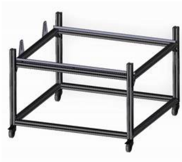
Abbildung 22: mobiler Werkzeughalter für das Laserwerkzeug. Der Werkzeughalter diente auch zum Transport des Laserwerkzeuges zu den Versuchsfeldern mittels KFZ.
