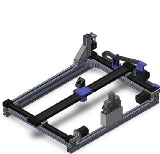
Abbildung 5: Verwendetes Portalsystem für das Laserwerkzeug. Die Kollimatorhalterung sowie das Spiegelsystem ist auf den Achsen des Portalsystems angebracht. Zudem ist die 3D-Kamera unterhalb des Schlittens abgebildet (blaues Teil in der Mitte des Bildes).
