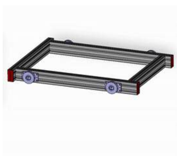
Abbildung 23: freier Werkzeugrahmen für das Laserwerkzeug von Permarobotics. Dieser dient als Verbindungsstück zwischen Permabot und Werkzeug und diente als Grundlage für den Aufbau des Laserwerkzeuges
