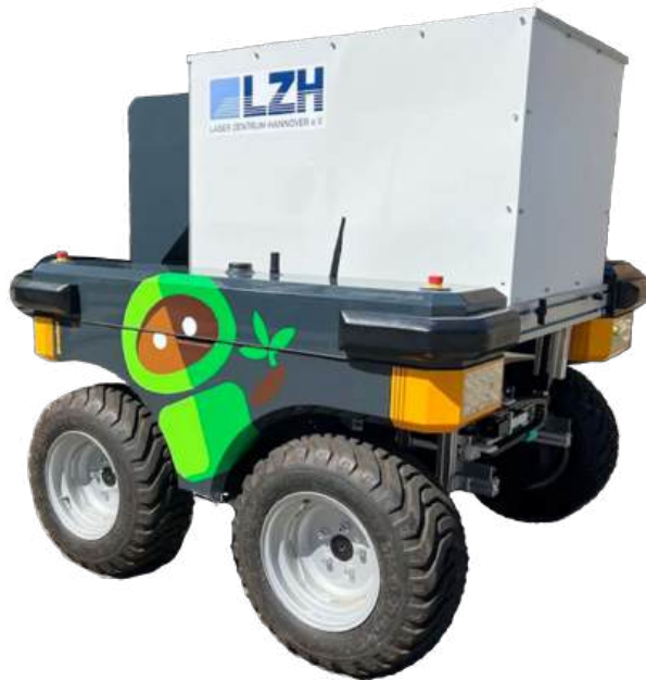
Abbildung 4: Darstellung des Gesamtsystems bestehend aus dem Permabot sowie dem Laserwerkzeug, welches in der Werkzeugaufnahme des Permabots eingeschoben ist.
